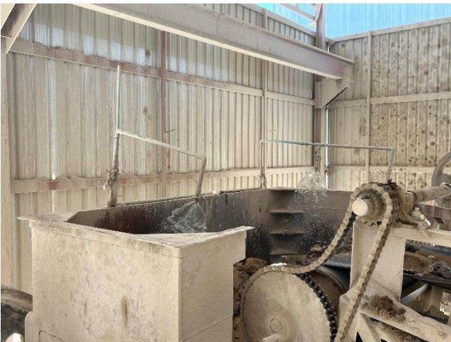
รูปที่ 2-22 ก. (ต่อ) โรงโม่หินที่เป็นระบบปิด และมีการติดตั้งระบบสเปรย์น้ำ
